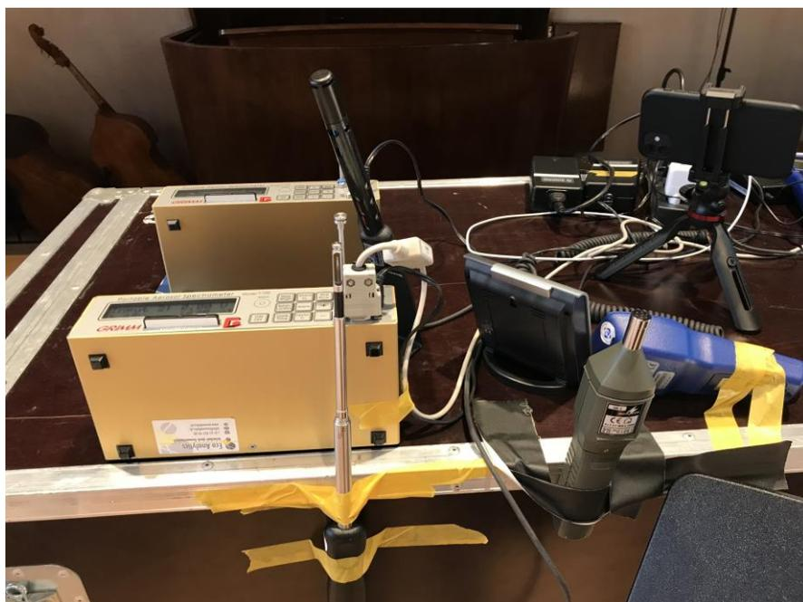
Abbildung 3 Anordnung der Messgeräte mit zwei Spektrometern für die Messungen an Chorsängern und -sängerinnen
